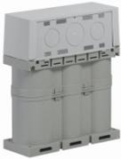
Le condensateur ALPIVAR3 est un appareil totalement sec conçu par association de bobinages élémentaires monophasés pour obtenir un appareil triphasé.
